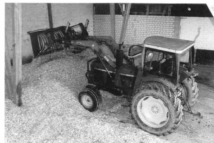
Mit dem Traktor wird der angelieferte Brennstoff auf den automatischen Schubboden geschoben.
