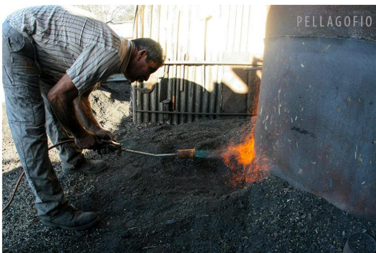
*El encendido de la carbonera metálica es sencillo y rápido, empleando un soplete en la entrada de aire principal. | FOTO Y. MILLARES*
